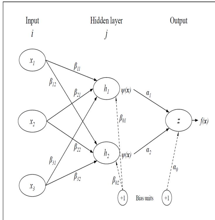
Abbildung 1: Feed-forward neural network mit zwei hidden und einer Output-Einheit; Quelle der Abbildung: Schupp et al. 2015, S. 466
