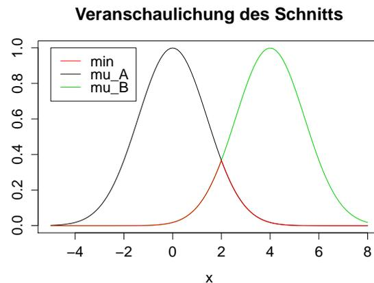
Abbildung 6: Die rote Kurve entsteht als Minimumskurve der charakteristischen Funktionen der Fuzzy-Mengen  $A$  und  $B$ . Sie beschreibt gerade den Graphen der charakteristischen Funktion der Fuzzy-Menge  $A \cap B$ .
