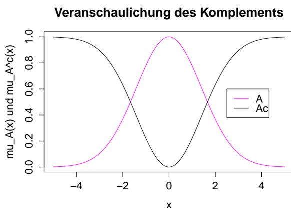
Abbildung 4: Den Graphen der charakteristischen Funktion von  $A^c$  erhält man durch Spiegelung des Graphen der charakteristischen Funktion von  $A$  an der horizontalen Funktion  $h(x) := 0.5$ .
